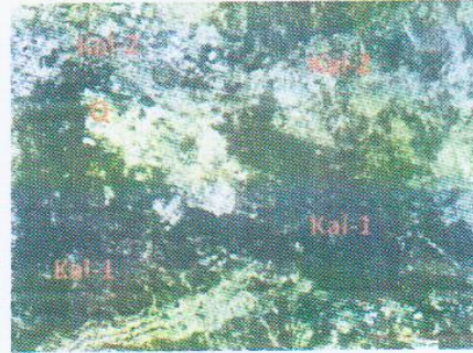
Şekil 1. Kayaç içerisindeki birincil (Kal-1), ikincil (Kal-2) kalsit ve Kuvars (Q) mineralleri (Çift nikol (sol - sağ)). Figure 1. Primary (Kal-1), secondary (Kal-2) calcite and quartz (Q) minerals were observed in rock (Crossed polarizers (left- right)).
